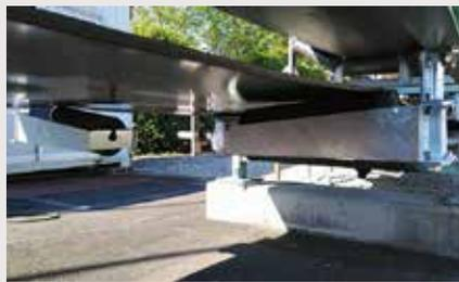
左右分割式のアイドラのため、ベルト中央部はローラとの接触が発生せず、搬送物の落鉋の軽減に効果を発揮します。
