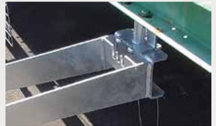
支点シャフト側のブラケット内側に3つの軸受けを設けており、前傾・標準・後傾、それぞれのローラ角度の調整が簡単にできます。
