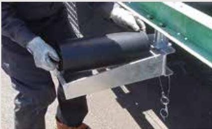
ブラケットのリンチピン2箇所を外し、支点シャフトを中心に歩廊側へ回転させるだけで簡単にローラを交換することができます。
