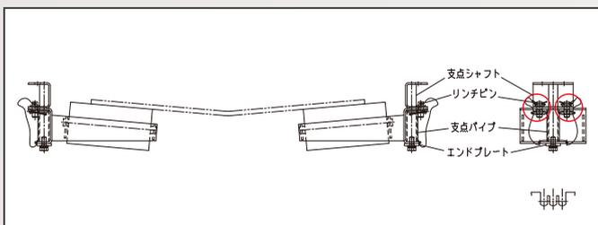
**2** 支点シャフトを中心に歩廊側へ回転させ、ローラを交換する。
