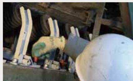
傾けたスタンドを元に戻し、最初に外したボルトでスタンドを固定すれば、新しいローラへの交換作業は完了です。
