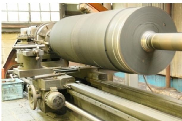
ゴムロールの旋盤加工
